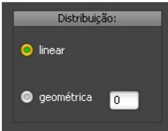
Em malhas grandes, com mais de sete ou oito cabos em cada direção, pode-se economizar uma quantidade significativa de cabos (e, conseqüentemente, de soldas, mão-de-obra para abrir valetas, prazo da obra, etc.) se colocarmos mais eletrodos nas bordas da malha e menos no centro - veja a teoria no livro **Malhas de Terra**.
